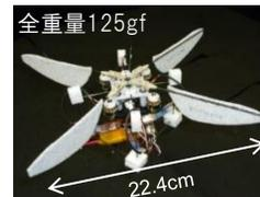
Fig. 6 4枚翼羽ばたき機試作機
