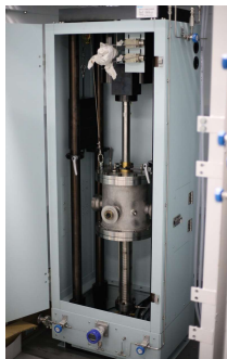
600°C 高温水素ガス中 材料強度試験装置
