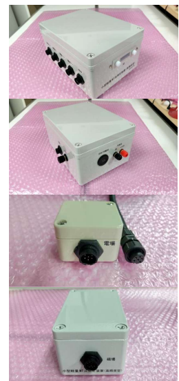
小型MT探査装置の試作3号機(C3の筐体および磁場センサと電場プリアンプ)
