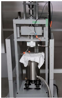
10 MPa高圧水素ガス中 材料強度試験装置
