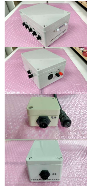
小型MT探査装置の試作3号機(C3の筐体および磁場センサと電場ブリアンプ)
