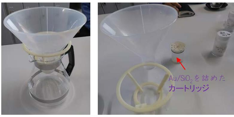
この方法により、色々な大きさのシリカへ金ナノ粒子を担持することができます。シリカの大きさにより、水や日本酒のろ過速度を変えることができます。現在、こうして作ったAu/SiO<sub>2</sub>をカートリッジに詰めて使うろ過器を開発しています。写真のものは家庭や居酒屋等での使用を想定したサイズになっています。お酒のモデル溶液やお酒で実験して、硫黄化合物が除去できることを確認しています。
